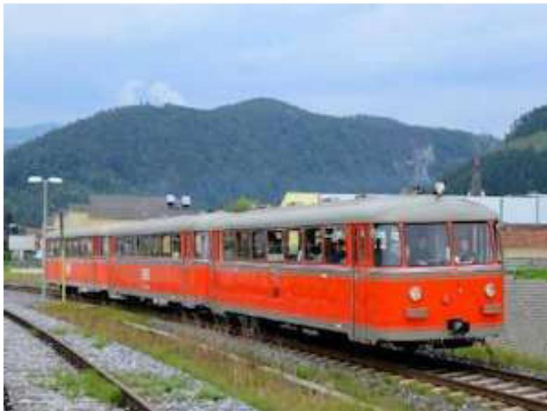
Die bei der GKB als VT10 bezeichneten Uerdinger Triebwagen prägten über Jahrzehnte den Personenverkehr bei der Graz-Köflacher Eisenbahn und waren als der „Rote Blitz“ bekannt und beliebt. Der Triebwagen VT 10.02 mit der Fabriknummer 85302 wurde gemeinsam mit dem Triebwagen VT 10.01 am 28.4.1953 bei der GKB in Betrieb genommen. Der VT 10.02 gehört somit zu den ältesten erhaltenen zweimotorigen Uerdinger Fahrzeugen.
